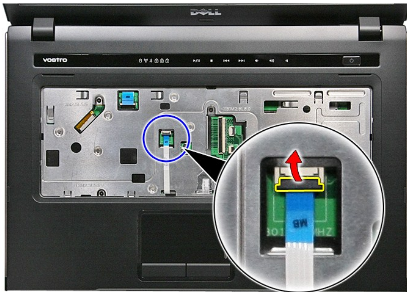
13. Odłącz kabel danych tabliczki dotykowej od złącza na płycie systemowej.
