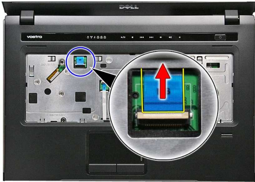
12. Odchyl zacisk mocujący kabel przycisku multimediiów do płyty systemowej.
